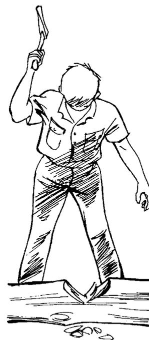
Hauen wir in der Richtung der Holzfaser, so schneidet das Beil in das Holz ein. Durch die Keilwirkung wird das Holz gespalten. Schlagen wir quer zur Faserrichtung, trifft die Schneide auf einen harten Widerstand, das Beil federt zurück oder fällt ab.
